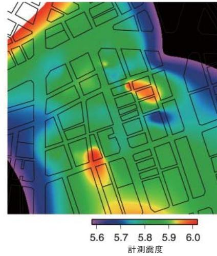
きほど揺れやすい。図に示したように400m四方の範囲でも、これだけの違いを見ることができる。一方で、固有周期の短い(数字の小さい)地盤が揺れにくいのは間違いないが、地震の揺れは地盤の特徴だけでなく、地下深くでの地震の起り方にも大きく影響されるため、地震が起きたときに必ずしも揺れが小さいとは限らない。図3は、予想される大地震が起きたときの震度を示したものであるが、地盤固有周期の図とよく見比べると違いがあることが分かる。
