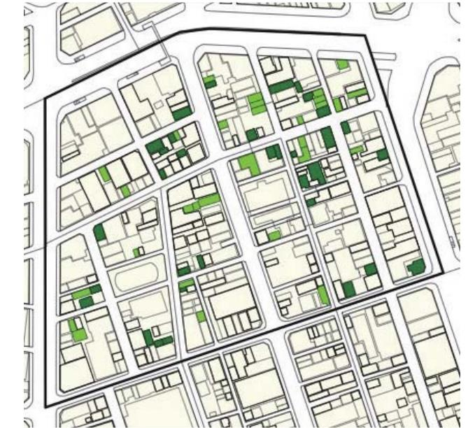
低層の建物で多く用いられていたのはラスモルタルであり、その分布を右図に示す。その中でも1981年以前に建てられた建物(濃い色)に使用されているラスモルタルは、他の外壁構法と比較してメンテナンスが重要なので、定期的な点検をすることが望まれる。
