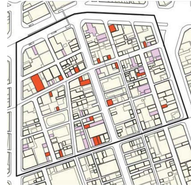
外装材の種類とその取り付け方により、そのリスクが異なる。取り付け方はその建設年代からある程度想定することが可能である。中高層建物などで比較的多く用いられていたのがALCパネルであり、その分布を左図に示す。その中でも1981年以前に建てられた建物(濃い色)に使用されているALCパネルは、挿入筋構法を用いている可能性が高いため、大地震の際には大きな被害が出ると思われる。
