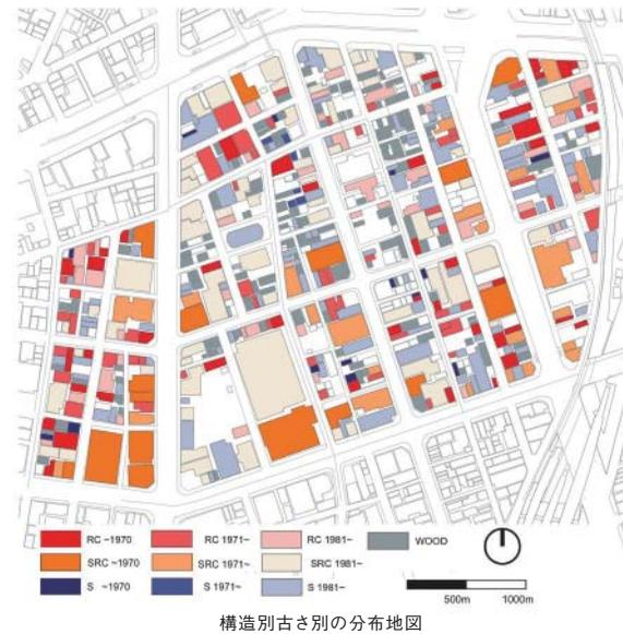
個別の建物の構造を木造(W造)、鉄筋コンクリート造(RC造)、鉄骨鉄筋コンクリート造(SRC造)、鉄骨造(S造)の4種類に分け、建物建築年代をRC造の柱の補強筋改正の1971年以前、1971年から建築基準法の耐震規定の大改正があった1981年まで、1981年以降の3期に分け、その分布を地図上にまとめた(図4)。この地域での分類をみると、RC造、SRC造、S造の順に古いものが多くっており、木造に関しては、築50年以
