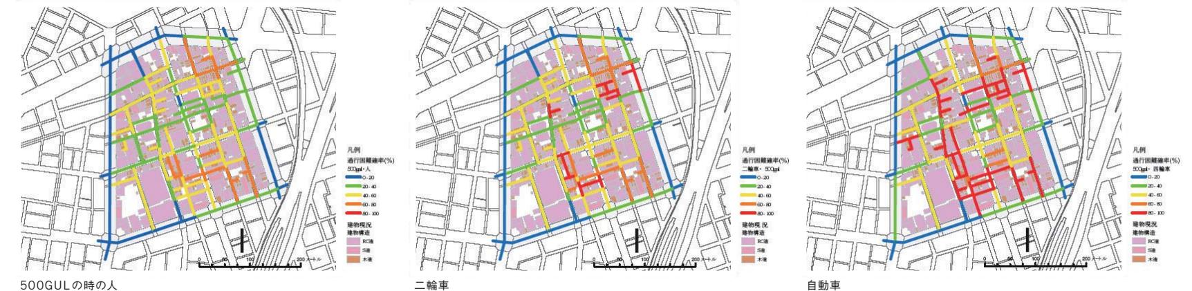
災害時の通行困難な街路の発生は、消火活動や避難の妨げになり、地震の被害を拡大させる。このような通行困難な街路の発生を、簡単な仕組みのコンピュータシミュレーションによって予測した。想定する地震は、最大加速度300、400、500ガルの3種類とし、瓦礫が建物高さと同じ幅で周り全体に飛び散ると想定した。街路が瓦礫に覆われていない幅が、0.1mであれば人は通れない、1.0mであれば二輪車が通れない、2.0mで
